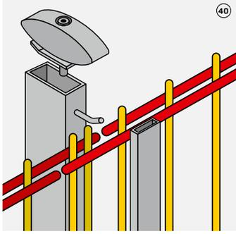
Die Gitter des Systems R-S werden an den Pfosten überlappend montiert. Hierzu werden die Gitterenden an die Haken der Pfosten gehängt. Anschließend wird das Rechteckrohr an die Haken gehängt. Durch die Abdeckkappe mit Konterplatte wird dann die Abdeckung an den Pfosten geschraubt. Das Rechteckrohr klemmt die Gitter an die Pfosten. Schnelle und einfache Montage auch für Anfänger.
