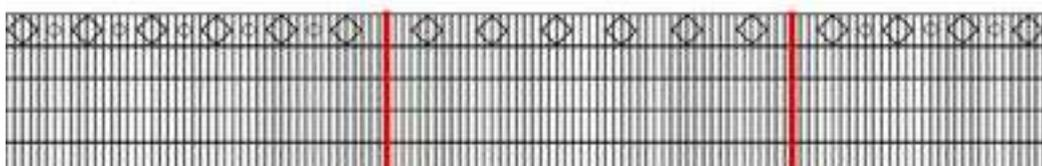
Schmuckzaun Dekor Karo Typ I und Typ II in einer Zaunanlage im Wechsel montiert.
