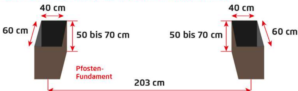
Abb. 1 Die Fundamenttiefe ist eine Mindestangabe und kann regional variieren!
