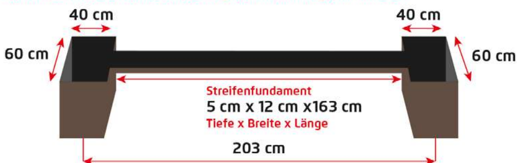
Abb. 2 Die Fundamenttiefe ist eine Mindestangabe und kann regional variieren!
