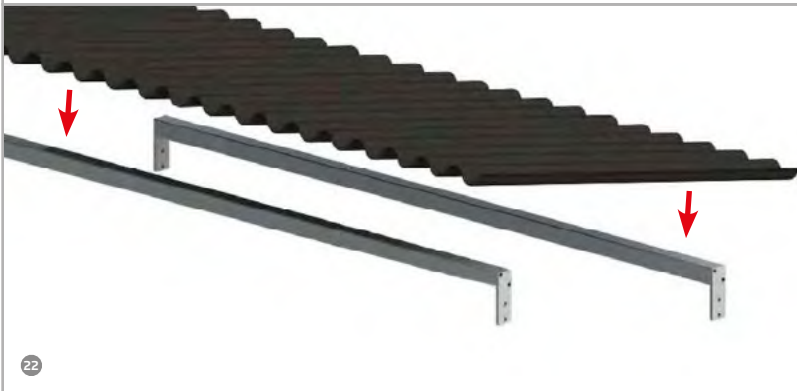
Abb. 8 Anschrauben der Wellpappe am Dach!
