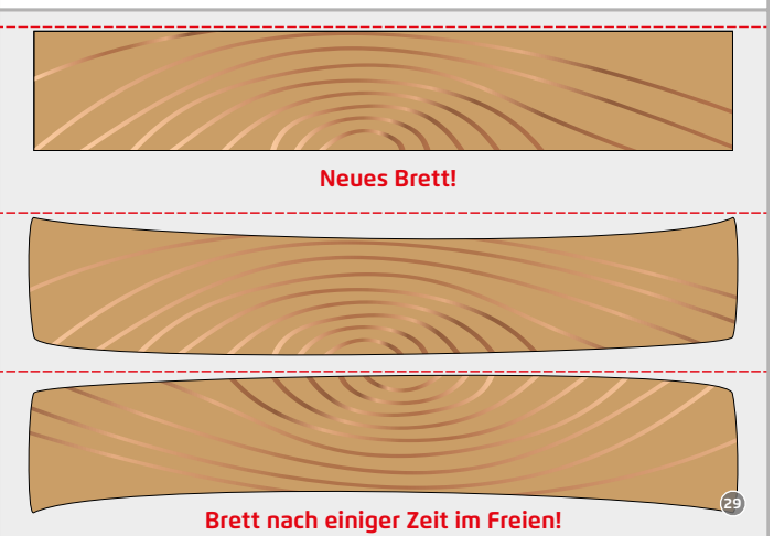
Abb. 13 Holz arbeitet und verändert seine Form!
