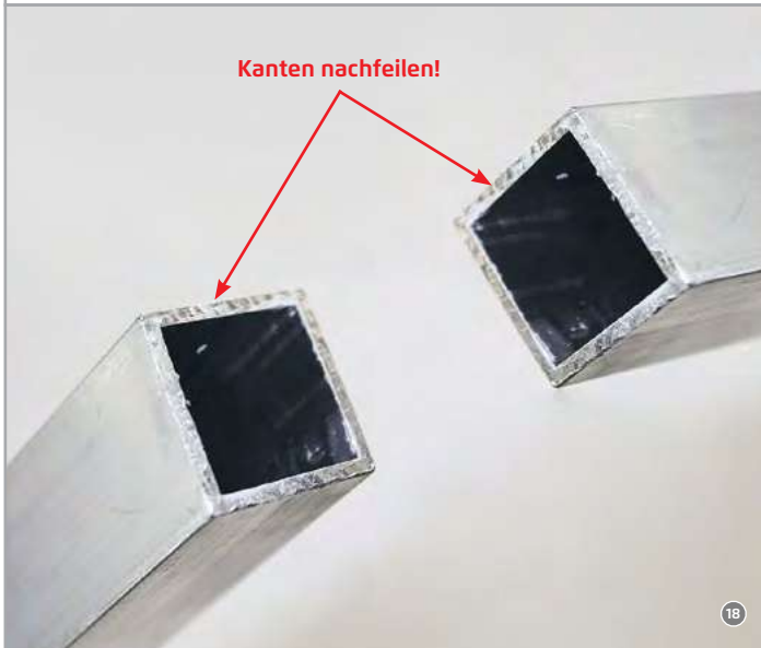
Abb. 1 Vierkantrohre auf gewünschte Länge sägen!
